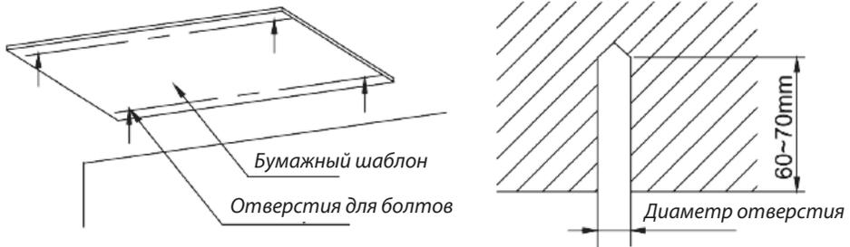
Установите анкерные втулки М10 в отверстия, вставьте в них установочные болты и затем удалите бумажный шаблон.
