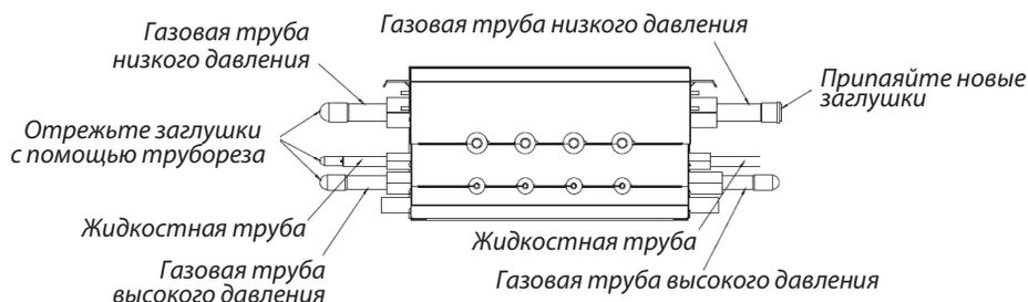
Возьмите два шумоглушителя, вставьте патрубок с диаметром 22 мм шумоглушителя 1 в газовую трубу высокого давления и патрубок с диаметром 28 мм шумоглушителя 2 в газовую трубу низкого давления с левой стороны блока, произведите пайку.
