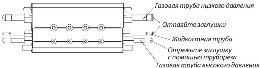
Возьмите два шумоглушителя, вставьте патрубок с диаметром 22 мм шумоглушителя 1 в газовую трубу высокого давления и патрубок с диаметром 28 мм шумоглушителя 2 в газовую трубу низкого давления, произведите пайку.
